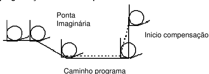
Fig. 4-6 Caminho da ferramenta em programação imaginário
